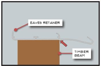
5 POSITION THE EAVES RETAINERS BETWEEN EACH BAR. ALIGN THE SMALL NIB ON THE BOTTOM OF THE EAVES RETAINER WITH THE EDGE OF THE TIMBER BEAM.
